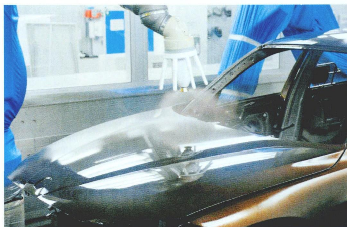
图 3 每台车都需要喷涂最为环保的四层水性车漆, 待四层喷涂完成后, 每辆车就有了不同的个性, 缤纷色彩足以满足客户的不同需求
