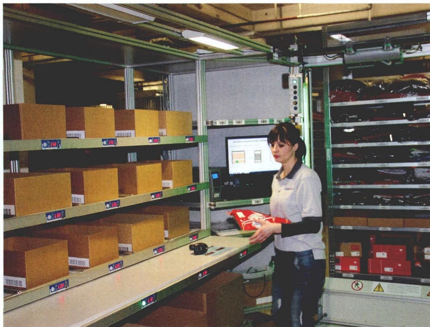
图 1 呈现绿色光对工作人员则标志着移动运输车已经就位，可以安全的在库房里工作
