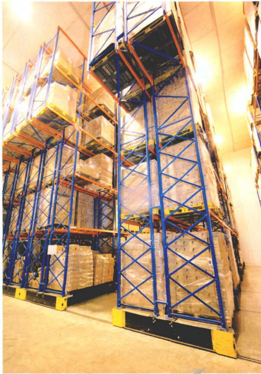
相同托盘位数的仓库，使用移动托盘货架的冷库比传统冷库少用 50% 的能源
