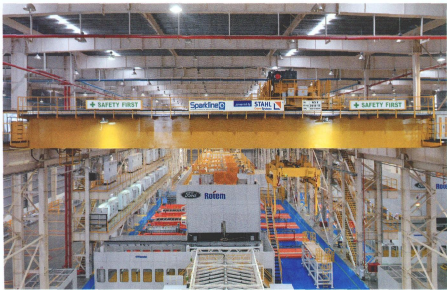
图 1 在空中快速更换模具：起重机按 60 m/min 的速度靠近预先设定地点，提起模具并移动到指定储存地点，再将下一个模具装进冲压机的过程也是全自动的
