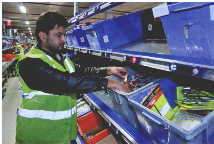
图2 高效人体工学拣选系统解放了作业人员双手，同时避免远距离行走，大大提高拣选效率
