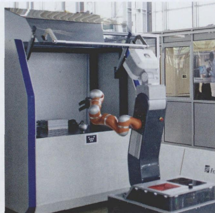
图3 弗劳恩霍夫工厂运行和自动化研究所 (IFF) 研制出了可用于移动操作平台的“Annie”助理机器人
