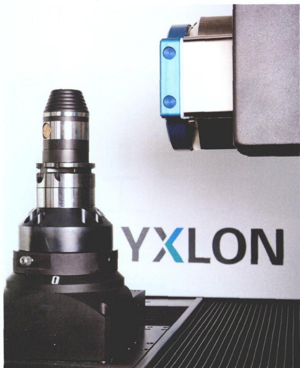
图 2 检测件借助工件座放置在回转工作台上。该图为 FF20 CT 的回转工作台, 包括高精度 HSK 夹头的工件座。决定径向跳动质量和测量精度的关键是海德汉公司的角度编码器模块
