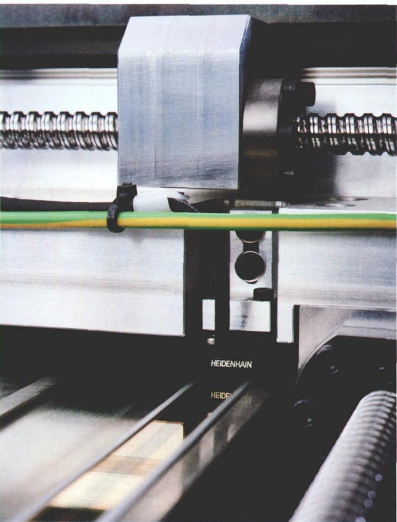
图 3 配海德汉直线光栅尺的依科视朗 FF20 CT。海德汉公司的 LIDA 487 敞开式直线光栅尺使检测件能高精度地运至 X 光管前。测量步距只有 0.05μm
