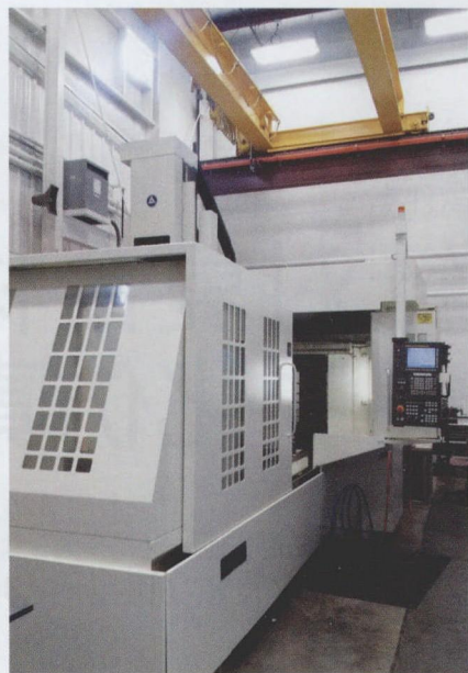
图 3 最大承重为 13200 lb，Bridgecenter-10 加工中心为较大模具的粗加工提供了额外的能力和功率
