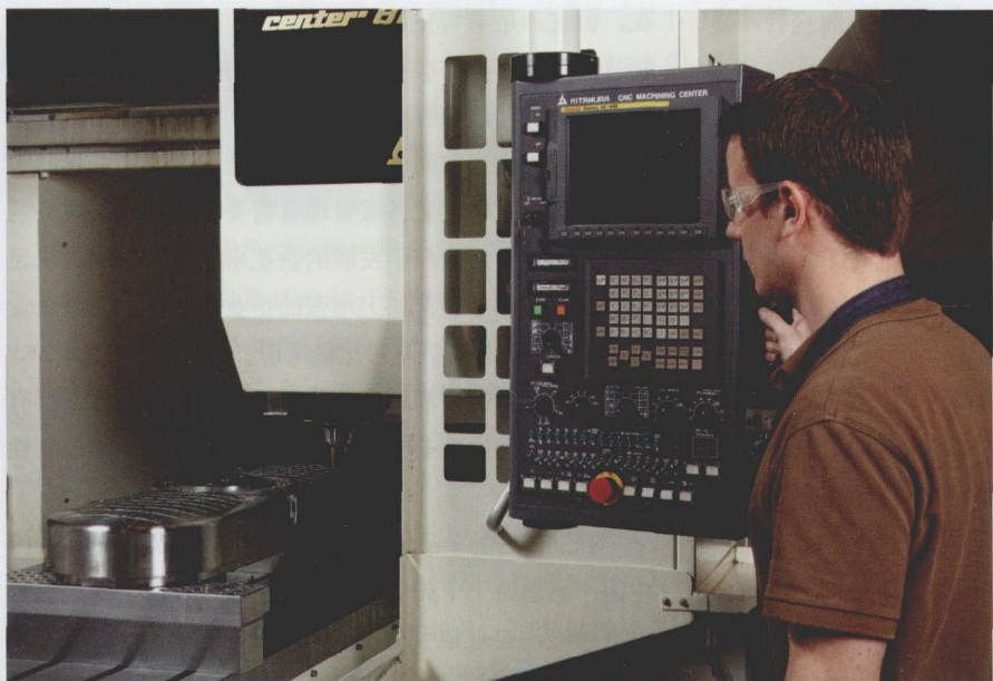
图 1 尽管 Kitamura 公司的 Bridgecenter-8F 加工中心非常适合快速切削大量钢材，但 EVCO 公司不必为速度而牺牲功率。图中，模具制造工人 Larry Dean 正在利用机床对经过淬硬的 P20 钢模具中的肋状结构进行高速切割，该模具将用于 1500 t 的压力机中
