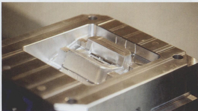
图1 更高的表面精度和更小的公差意味着降低二次处理次数，避免产生模具飞边
