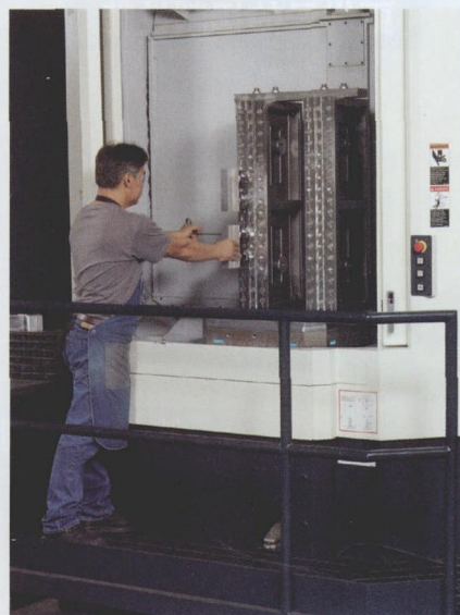
图2 像Sousack Pongrattana这样的操作人员，通常会在一个工件加工时夹装另一个工件，这对于突发的生产计划的变更非常有用，让车间能够实现机床停工的最小化
