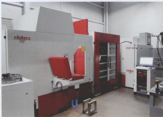
图7 该品牌的新电极加工装置由两个Roders RXP 500 高速加工中心与一个来自相同供应商的RCS2 机器人构成,是Unique 公司近期耗资350 美元采购的最新设备之一
