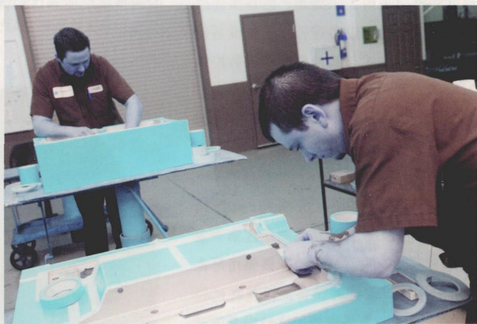
图7 Custom Etchde 公司工程师 Ed Socciarelli 先生（前）和 Jake Miletta 先生在为化学腐蚀加工准备模具，这项技术要求丰富的经验和专业技术，而这种人才正在逐年减少
