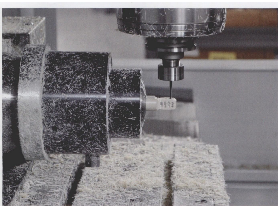
图 2 这台 Haas VF2 是一台 5 轴磨床，MDI 专门用这台机床来加工非金属部件，如本图所示的 PEEK 塑料工件（嵌片）。许多医疗部件都采用了非金属材料并要求加工企业具备针对各种材料的专门经验
