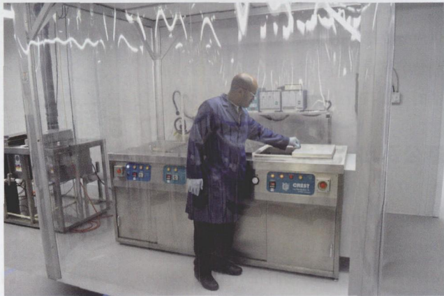
图 3 这间 100 000 级洁净室让 MDI 通过了 ISO 13485 认证。图内所示收尾加工设备之一是一台超声波部件清洗机
