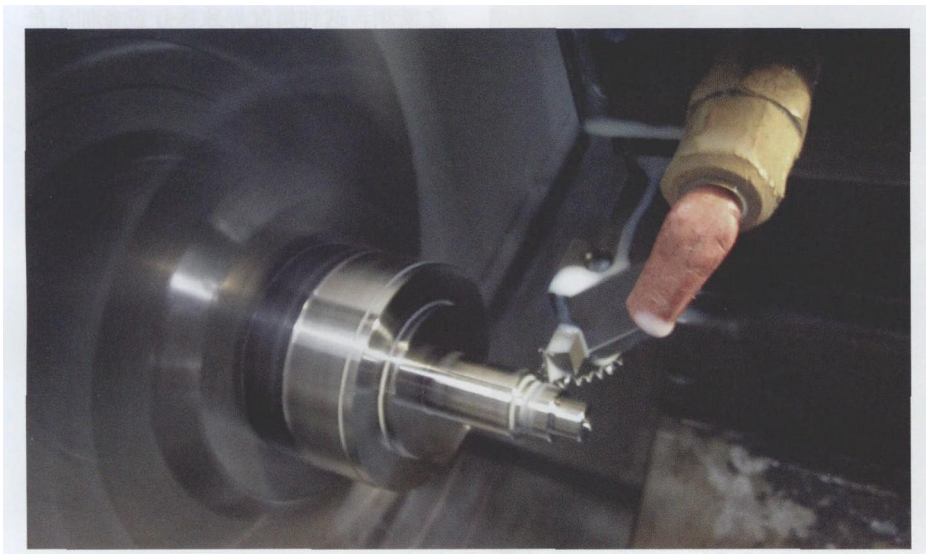
Christensen 先生已经使用过宽度为 0.0195 ~ 0.065 in 的沟槽加工镶件，其刀尖包括了尖头型和完整圆弧型，通常能够达到 16 ~ 32 R_a 的表面光洁度
