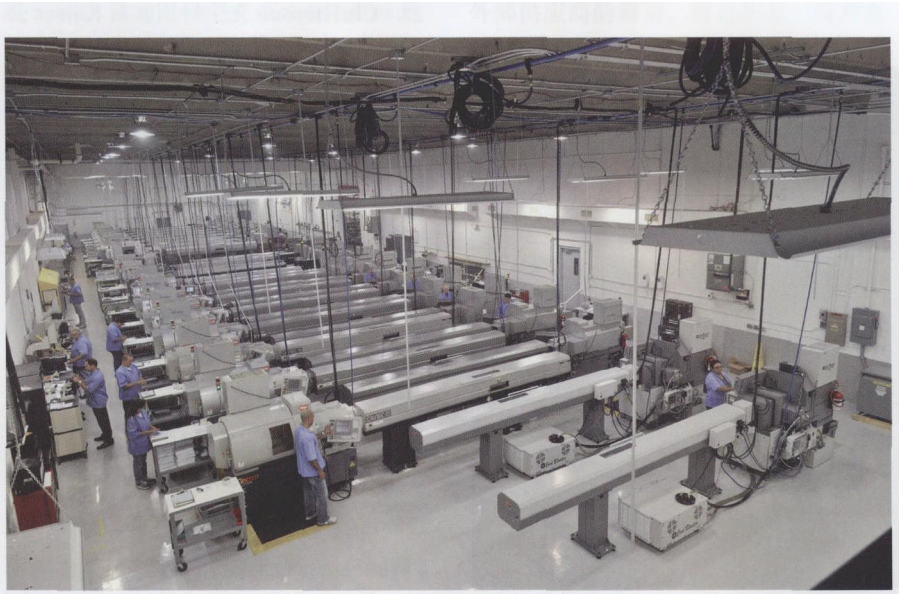
图 1 3D Medical Manufacturing 公司拥有 48 台瑞士型车床，还拥有 5 轴加工机床、线割 EDM 机床和机器人加载 CNC 磨床
