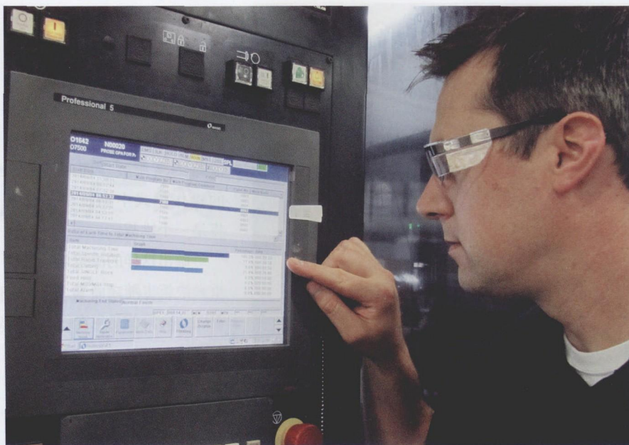
图5 加工结果页面提供了机床的性能报告，Cisewski 先生可以在车间或通过远程网络进行检查，页面上的数据有利于设备监控和操作人员效率的提高
