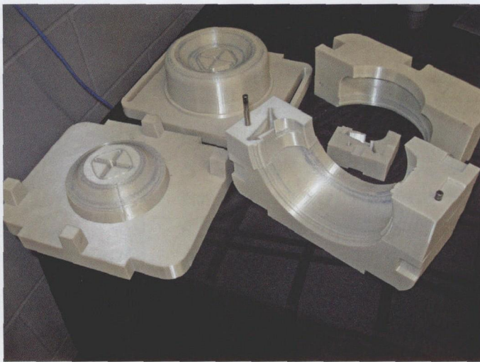
图 4 FDM 能够快速生产小批量产品，也能够制造用于大批量镜头生产的模具
