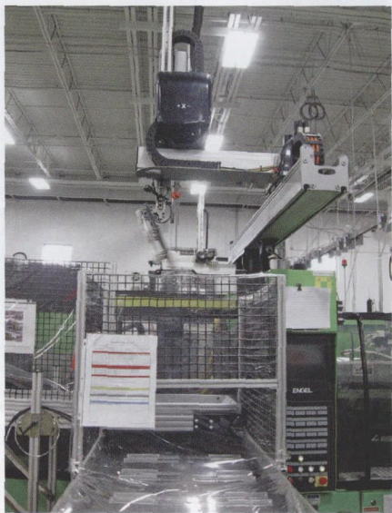
图 5 增材制造用于支持 Thogus 公司的自有设备，车间中装载机器人的臂端工具现在就是通过 FDM 生产制造的
