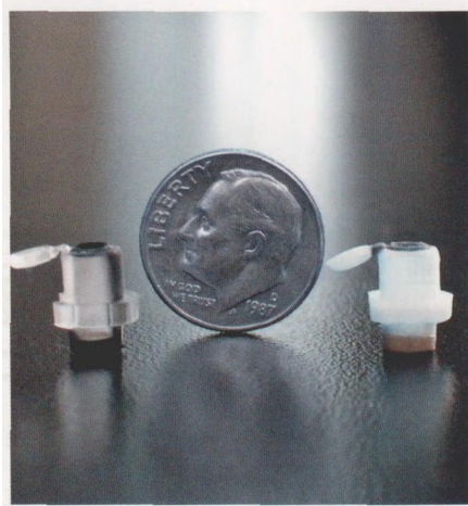
图 3 图中右侧的 PolyJet 零件是使用 Connex500 3D 打印的，左侧为注塑模具生产的零件
