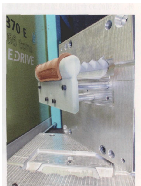
图 1 带有 PolyJet 镶件的铝模用于 2012 Arburg 60 t 电动压力机
