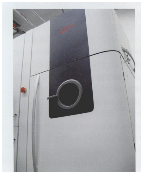
图 2 DiSanto 公司有两台 Arcam 电子束熔焊机，它们运行时十分安静，放在一间办公室中
