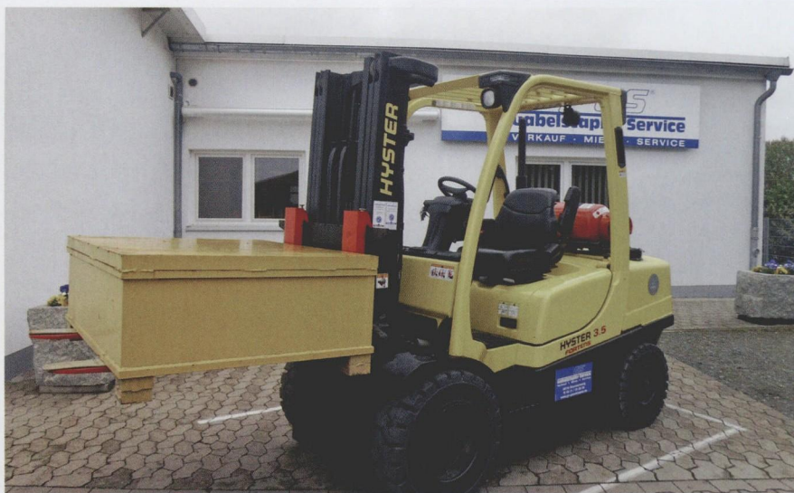
图 4 图中是一辆 Hyster 叉车，正在 GS 叉车服务处进行负荷试验
