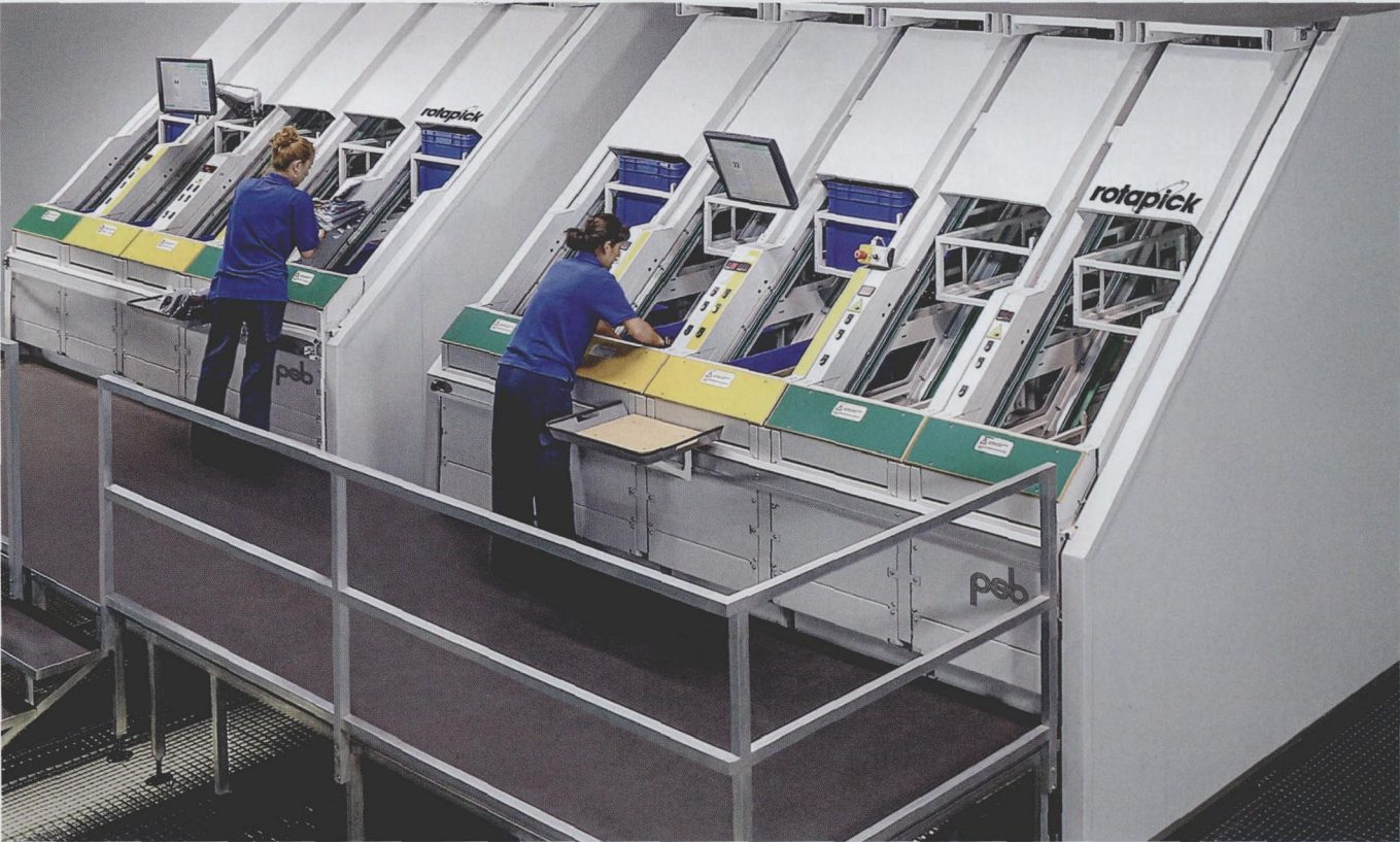
Mayoral 电子商务公司新配送中心的高效能货物处理系统每小时分拣货物能力可达 1000 余件
