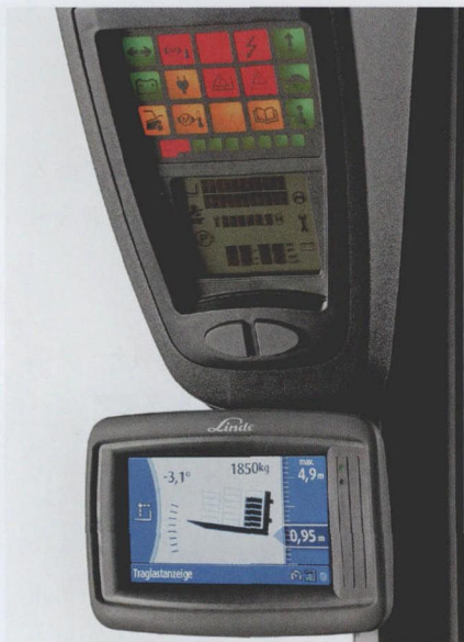
图5 借助于 Linde 安全导向器，叉车驾驶员可实时且可靠的监测车辆的所有重要功能
