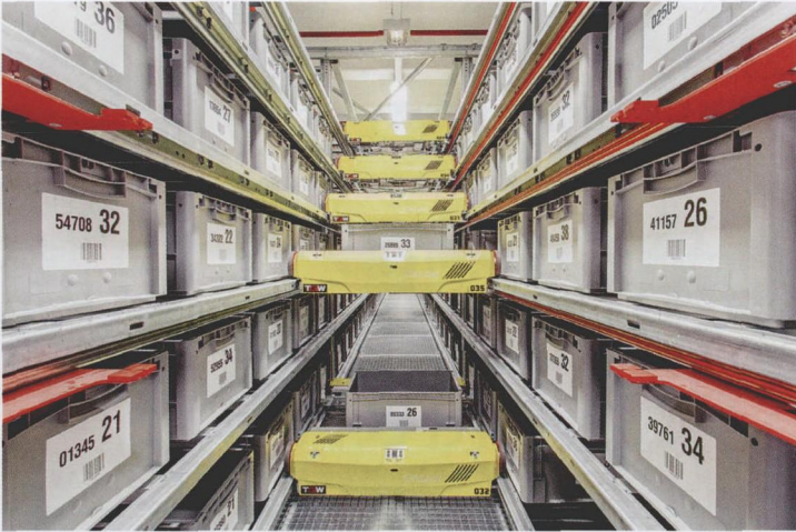
图2 在 Kärcher 的一个新的物流中心，70% 的订购委托是在有着 85 000 个容器调整场地的 AKL 仓库（自动化小件仓库）来完成货物包装和处理的。36 台穿梭车确保从各个不同的部门拣选货品
