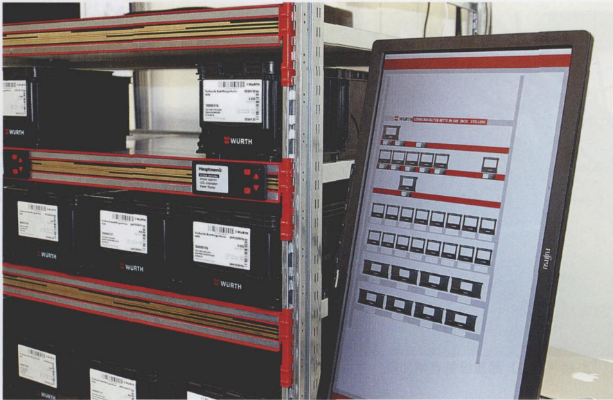
图 2 所有数据将自动进行储存，并在货架变化时传递到企业资源规划（ERP）系统
