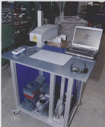
图 2 Ulyxe 安装在一台移动车上，因而可以灵活地放在相应的加工场地使用
