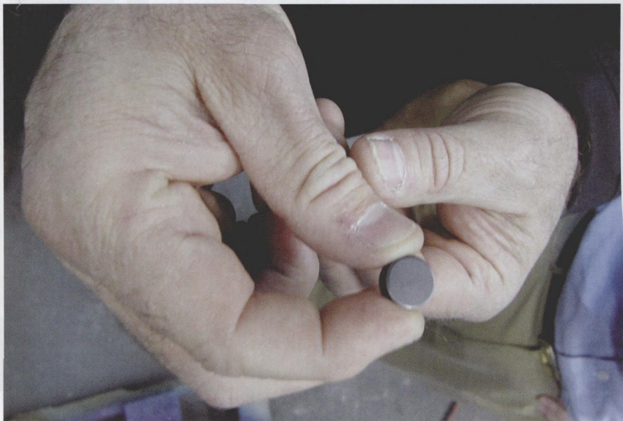
图3 公司有一份合同要求加工硬而脆的白口铁，结果选择了结实的、圆形的 CBN 刀片，强度好并增加了切削刃
