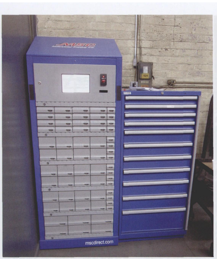
图4 作为公司精简工作的一部分，此刀具管理系统放在方便所有机器操作员的地方，他们能更快地取得他们所需要的刀具，公司管理刀具库存也更容易
