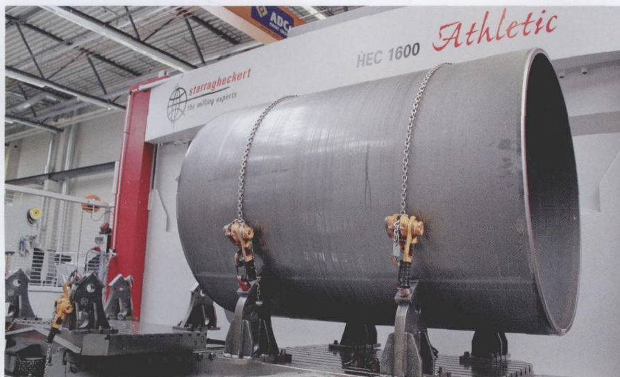
图2 加工中心的夹持面达到 1250 mm × 1600 mm，可以对干涉直径达到 3000 mm
