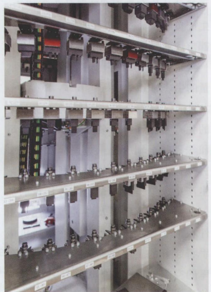
图3 机器人可存储 108 个电极,保证 EDM 的持续加工,经常使用 50 或 60 个电极烧蚀一个型腔
