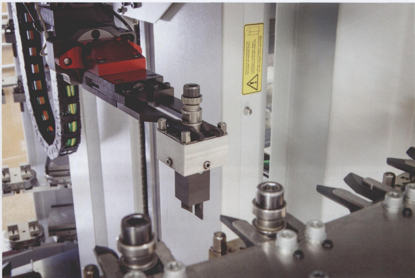
图1 CMD 公司的 Erowa Compact 机器人拾取和放置系统显著提高了车间的 EDM 利用率
