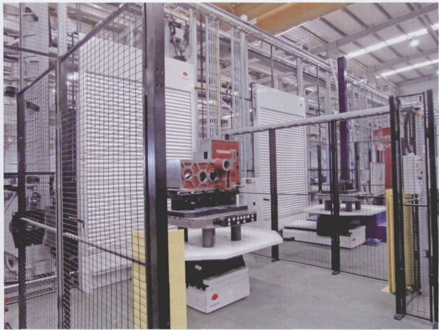
图 1 齿轮箱体工件和机械夹具
