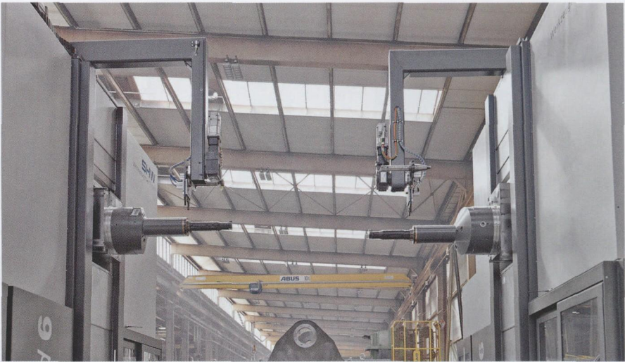
图 6 Powerspeed 6 型设备的两个立柱自动更换刀具并保持相互独立
