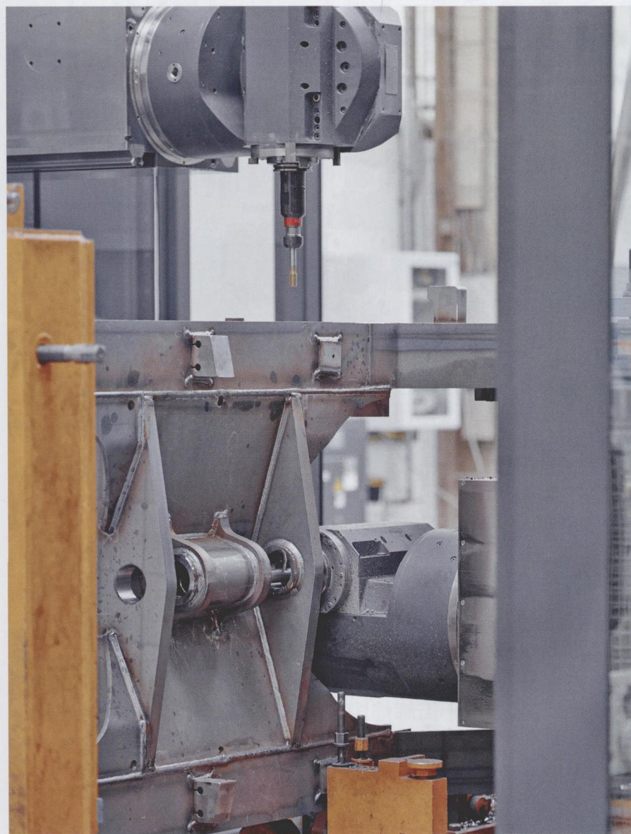
图 1 平行加工：当一个铣刀在攻螺纹（上）时，另一个铣刀同时在铣削（下）
