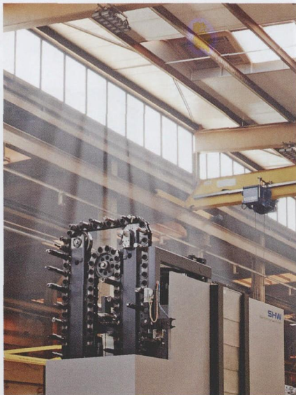
图 7 Powerspeed 6 型设备上的每个立柱都拥有一个可储存高达 150 把刀具的换刀装置
