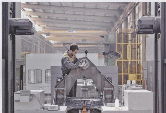
图4 在 Liebherr 公司所采用的 SHW Powerspeed 6 型加工设备上，可以对轮式装载机的前后车体进行加工
