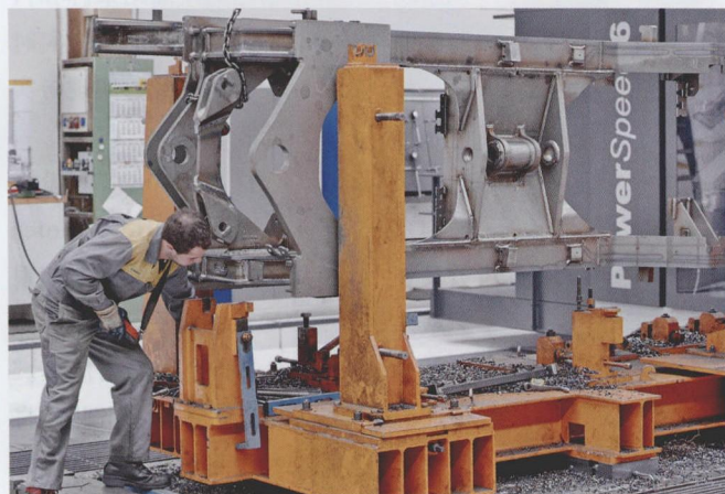
图3 由 Liebherr 公司自行加工的装备可以确保工件的位置精度
