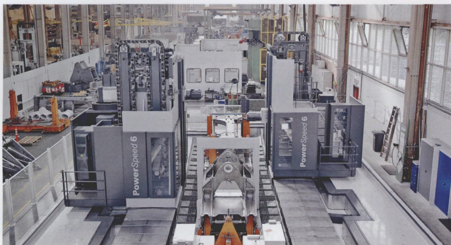
图2 一台拥有双机架、可实现平行作业的 SHW Powerspeed 6 型立柱式加工设备
