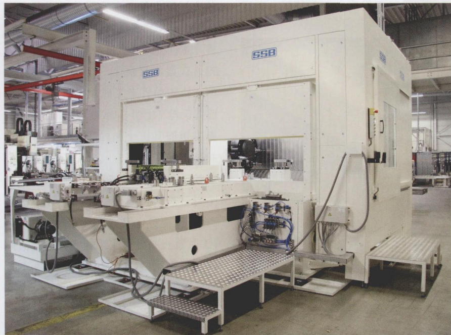
图 1 所设计的改良型 HFZ 加工中心适用于对大型、长型和重型纵梁部件的加工
