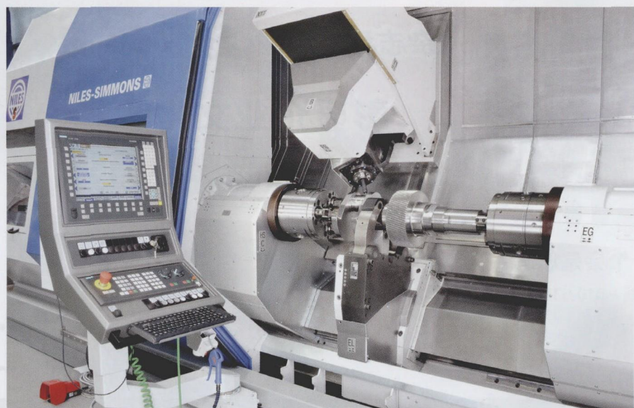
带有通用型车铣镗功能铣刀和 HSK63 高速加工轴的 N30MC 型倾斜床身机床设备
