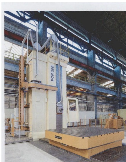
图 1 带有压板的 PCR 200 型 Union 卧式铣镗床可用于 Sket 公司对 Enercon 风能设备转子轮毂的加工,加工精度可以达到 0.02 mm
