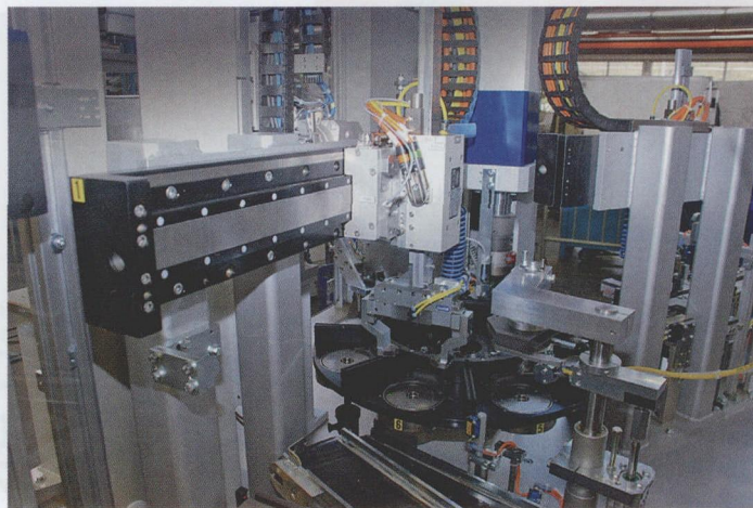
图4 两个线性轴承 HL 和 HN 的特点是动力性能高且结构紧凑
