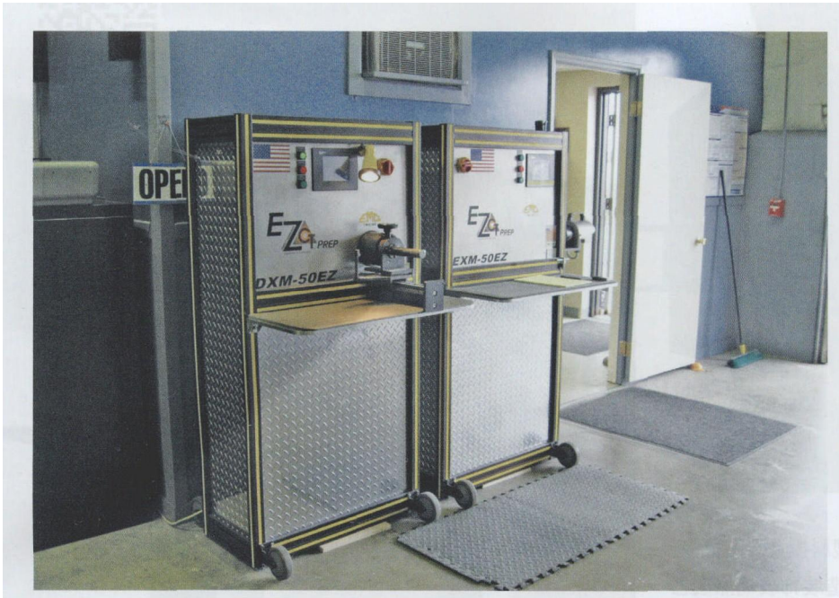
图3 Conicity 公司提供可编程的边缘加工机器，比如这些在现场进行边缘加工的大批量生产设施。在这里看到的两个不同配置的机器，以及立铣刀边缘加工
