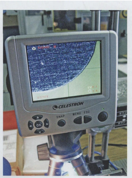
图4 当芯片的厚度根据切削刃曲线发生变化，该公司提供了可逐渐变细的边缘加工技术。此微观视图中展示了车削刀片，同理也适用于球头端铣刀
