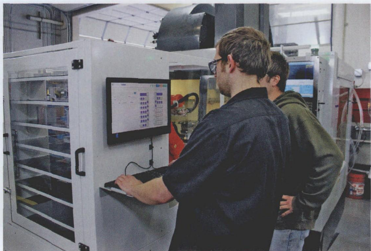
图2 通过此软件界面,可以很容易地把不同的零件号和夹爪套件分配到特定的货架位置
