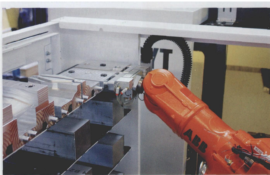
图3 机器臂从货架上拾取软爪夹具
