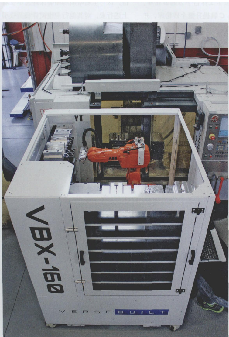
图1 该系统中的机器人不仅加载和卸载工件，还更换软爪工具，在货架顶部可见到各种台钳爪套件
