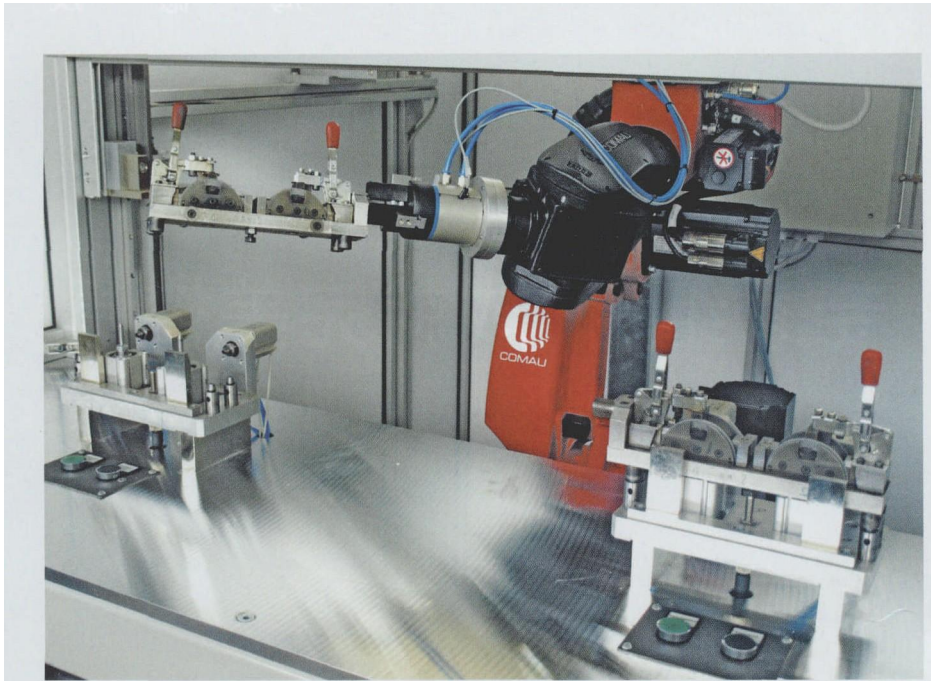
图2 机械手在工作站高速移动进行装 / 卸载工件
