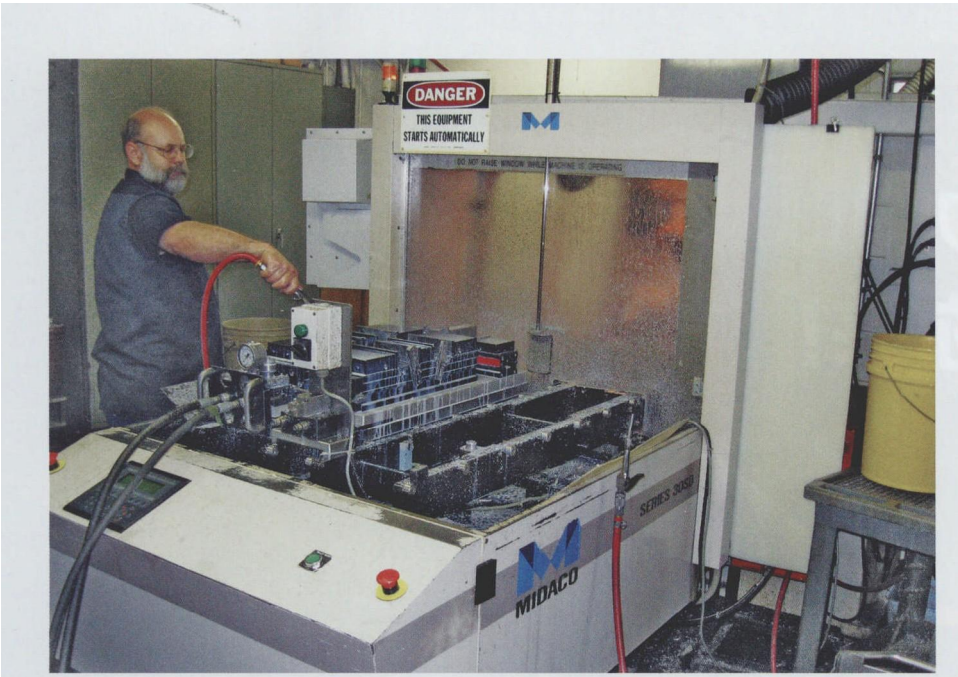
图 1 组长 Don Donahey 在清洁立式加工中心配套的自动托盘更换装置上的工件夹具
