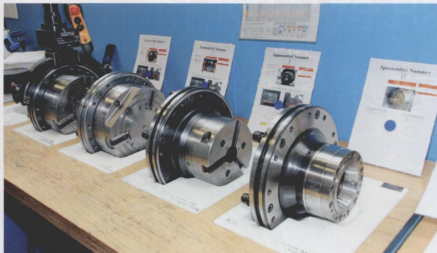
图3 带有连接凸缘的不同夹具可以快速安装在车床上
