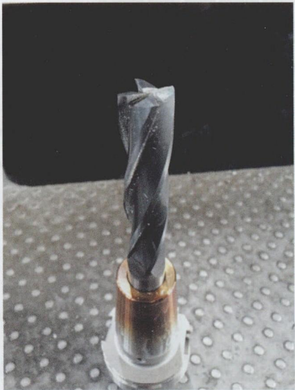
图 4 热缩刀柄夹持的山高刀具 \phi 20 整体硬质合金立铣刀
