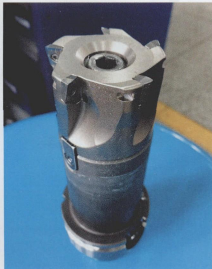
图 3 山高刀具 \phi 50 镶片铣刀刀盘及刀片
