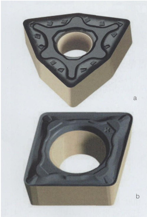
图 3 硬质合金涂层粗、精加工刀具 a 外圆粗加工选用瓦尔特老虎刀片（Tiger·tec）WNMG080404-NM4 材质 WSM30 b 外圆精加工选用瓦尔特老虎刀片（Tiger·tec）CCMT09T304-PF4 材质 WSM30
