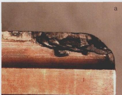
图2 刀具的磨损形式
