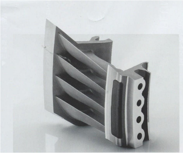
图 2 由于需要采用五轴内插加工，涡轮导向叶片的加工向软件系统提出了很高的要求
