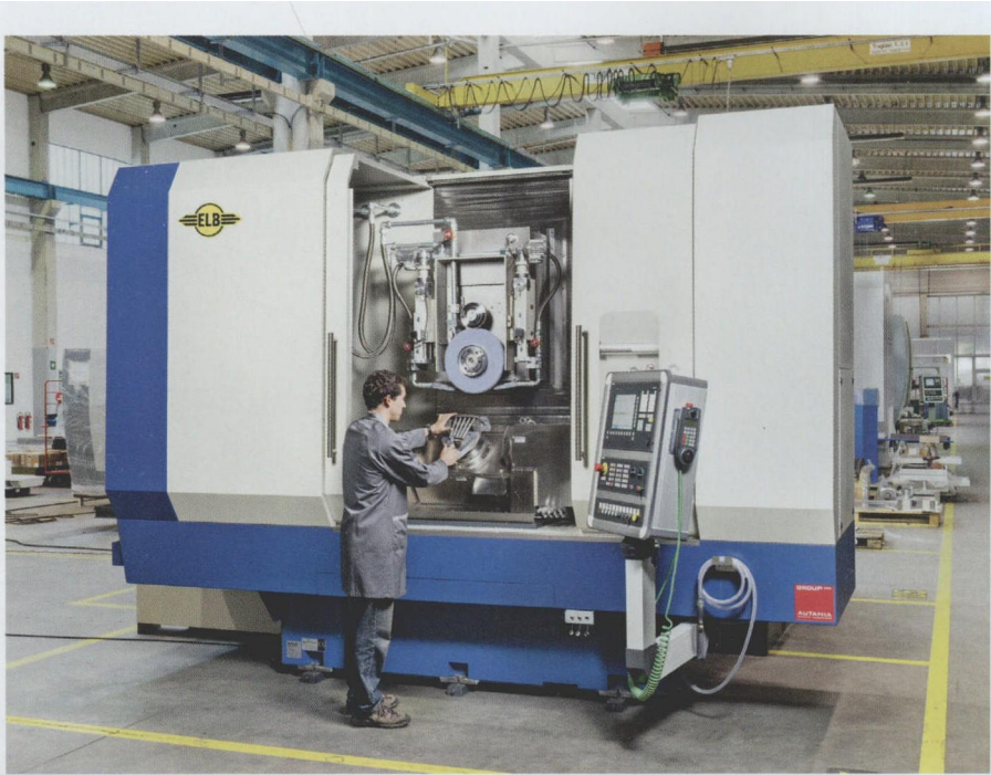
图 3 采用灵活的五轴或六轴加工中心，可以实现对涡轮导向和运行叶片的经济加工
