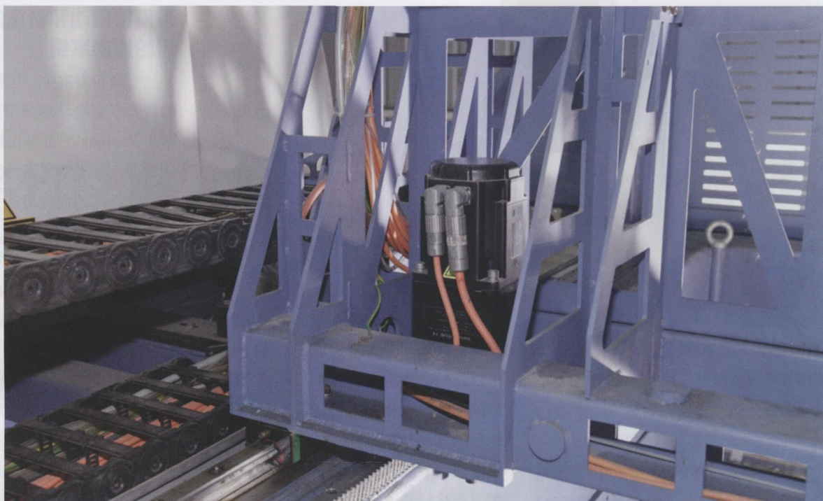
图4 新一代平床切割机也使用 Kollmorgen 带有 Micron 星形齿轮传动的 AKM 系列旋转伺服电机
