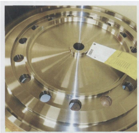
图4 此成品展示出很多荣田精机 VTL 能实现的细节, 比如用动力刀具钻出来的孔, 以及由机床的高压冷却系统把纠缠不清的切屑清理出来的深沟
