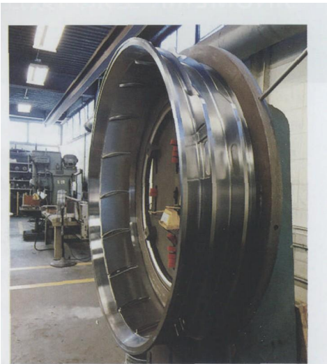
图1 这种排气罩曾经需要额外的步骤来加工键槽，现在在荣田精机 VTL 上，车削后便可以接着加工此键槽
