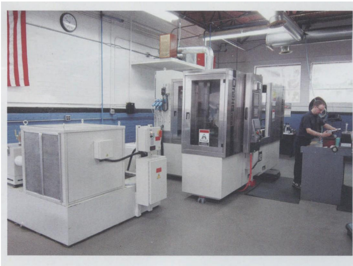
图3 机床的 250 gal 的离心过滤系统可除去小至 5 \mu\text{m} 的油屑, 以使其不会进入到轮和工件零件中, 否则可能会产生划痕。同样可将油冷却至约 70 °, 并通过机床的固定头部交付零件, 以防止磨削操作过程中主轴的膨胀
