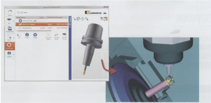
图 3 CAM 系统的加工程序模拟更准确真实地贴近生活，所选择的刀具 3D 模型可以被导入到软件中
