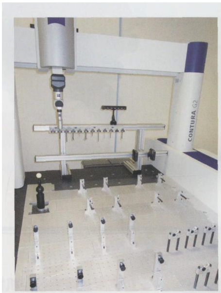
图 1 PDQ 正致力于开发无人值守进行坐标测量机检测的方法，利用坐标测量机和快速更换固定装置，实现多个工件无人值守测量
