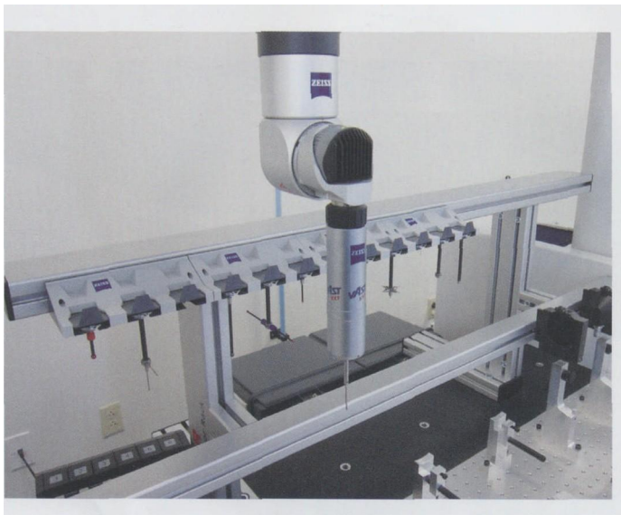
图2 这是一台 Zeiss Contura，带有 Vast XXT 扫描传感器和 RDS 铰接探针架。此坐标测量机能到达各种不同角度位置的工件细节
