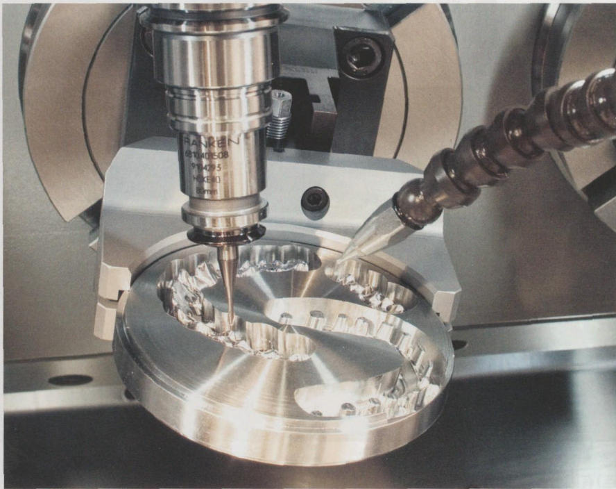
图 1 高精度、快速加工出最高表面质量的牙桥
