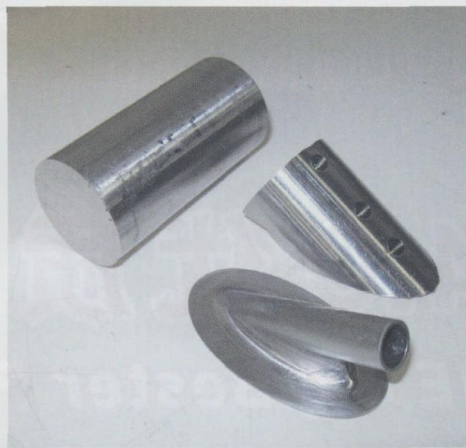
图6 这就是那个零件、其被切去的部分和被加工的棒料
