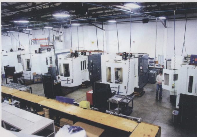
图 3 该厂加工资源的骨干力量，是一排类似的卧式加工中心，不同的只是托盘尺寸
