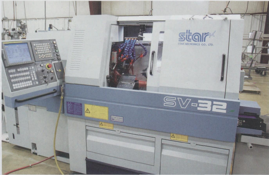
图 3 虽然瑞士式车床是十分有效的，但在加工长型和薄型零件时，Complexus 还利用其主轴机床，生产短型工具
