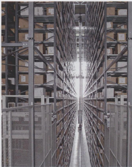
图4 瑞士的最大设备专营商 Pfister 公司实施了一个有75 000多个材料件处理工位的自动化小件仓库（AKL）。该自动化小件仓库（AKL）里有7部“Magito”型RBG进行作业
