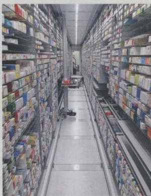
由 B 和 C 回转装置进行仓储货物存放操作的 Knapp-Store 系统设计方案，适合库存品种多的各种各样的物品且能够有效处理单件物品
