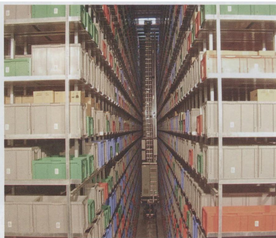
图 2 Klinkhammer 公司实施的自动化小件仓库 (AKL) 技术方案结构简单且确保无故障，并且使用的是可更换的标准件
