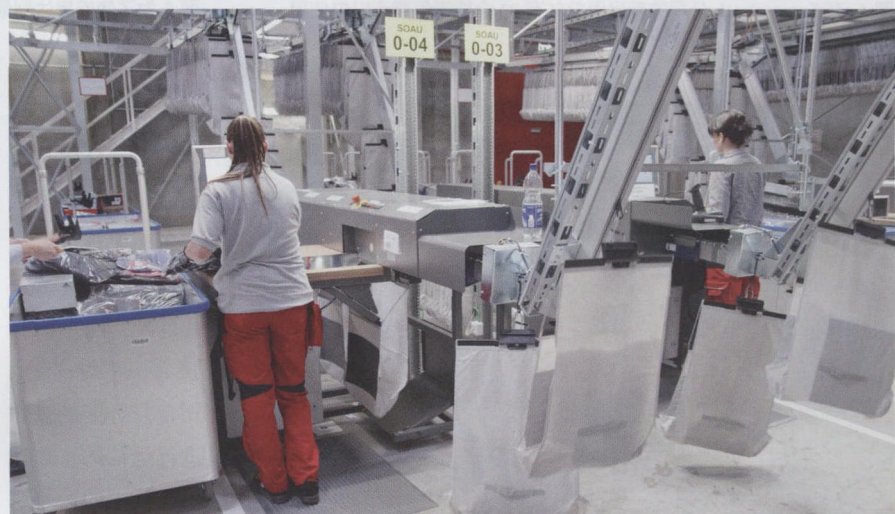
图 3 悬挂式口袋分类系统必须精准的做到一个小时完成 5000 件货物的分类运作
